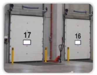
Seksiyonel Kapı, fabrika veya depo binalarının mal giriş çıkış, yükleme boşaltma noktalarında sirkülasyon sağlamak amacıyla kullanılan en dayanıklı ve en uzun ömürlü kapılardır. Seksiyonel Kapılar, geniş alanlar için kullanılan hızlı geçiş sağlayan ısı ve toz yalıtımı bulunan aydınlatma amaçlı penceresi açılabilen otomatik ve endüstriyel kapı sistemleridir.
